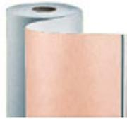
La guaina traspirante è una guaina universale **robusta e ultratraspirante**. All'elevata traspirabilità viene associata la **massima protezione contro la penetrazione di pioggia e vento** grazie alla particolare struttura a strati. La guaina Traspy ha una grammatura di 150 gr/mq e una significativa resistenza alla trazione.
